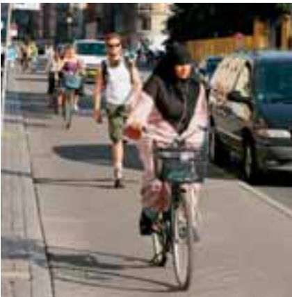
Cykelsti på et hævet felt i forhold til den kørende trafik er den trykkeligste form for cykelsti, da bilerne ikke så let 'kommer til' at køre ind på cykelstien. Nørrebrogade, København
